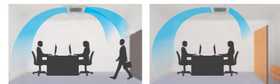
Alto nivel de confort evitando el flujo de aire frío directo sobre las personas.
